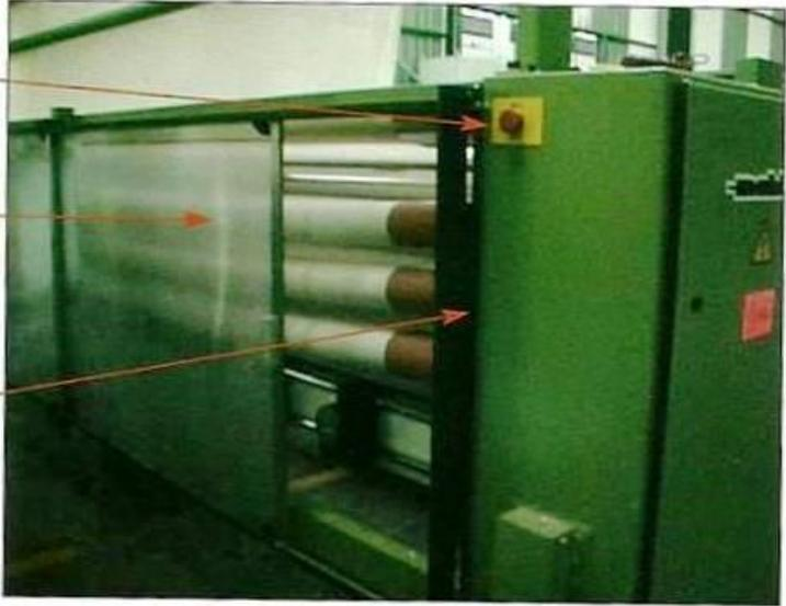
**⚠ Peligros derivados del sistema de sujeción y conducción del tejido. Peligro de arrastre o de aprisionamiento entre las cadenas de pinzas o agujas y los piñones.**
